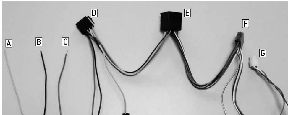
Многофункциональный комплект проводов предназначен для простого и быстрого подключения сабвуфера к штатным головным устройствам оснащенным разъемами типа ISO.
